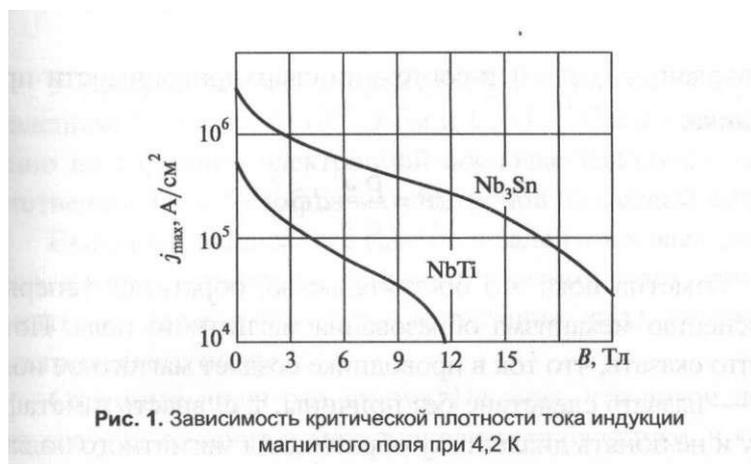
Рис. 1. Зависимость критической плотности тока индукции магнитного поля при 4,2 К
